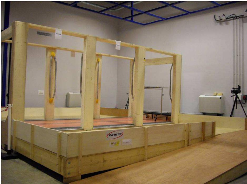
Des portes sont simulées de chaque côté du véhicule. Chacune d'elles mesure 1 m 15 de large et 2 m de hauteur.
