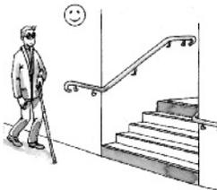
**(R)** Il est souhaitable que la main courante soit continue aux paliers d'étage afin d'éviter une rupture de guidage.
