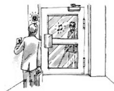
Lorsqu'il existe un dispositif de déverrouillage électrique, il doit permettre à une personne à mobilité réduite d'atteindre la porte et d'entamer la manœuvre d'ouverture avant que la porte ne soit à nouveau verrouillée. Il faut donc soit que la commande d'ouverture soit à proximité de la porte, soit que le temps de déverrouillage soit suffisamment long.
